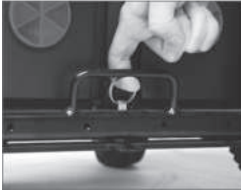
III. 28 Frigørelsesbolt på batteriskuffen
