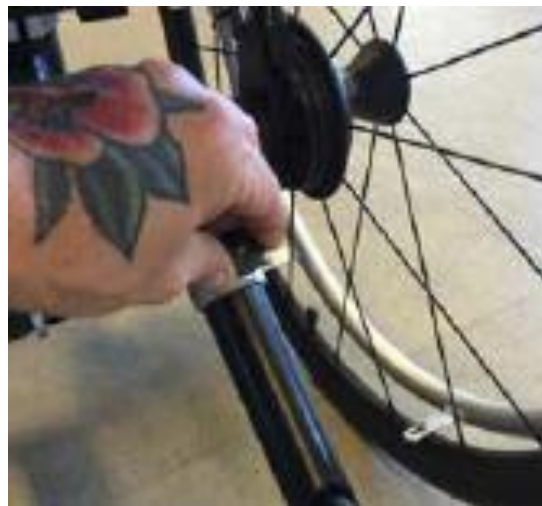
Fig. 09b Træk stemplet op væltesikringen ud
