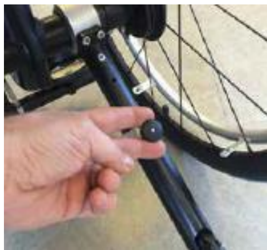
Fig. 09d Træk stemplet op væltesikringen ud
