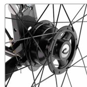
Tromlebremse på 20", 22" og 24" hjul. Anden version leveres på 12½" og 16" hjul
