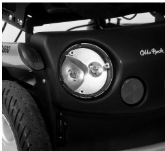
Bild 43: Byte av bakre blinkers och bakljus
