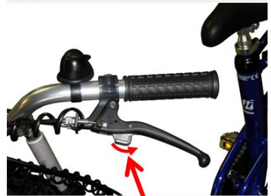
Håndbremse løsnet. Låsepalen løsnet.
