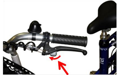
Håndbremse aktiveret. Låsepalen presset fremad.
