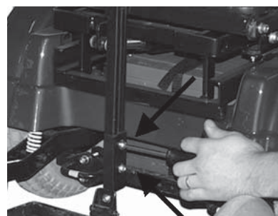
Figur 11 For at justere selve fodpladen op/ned skal skrueene som vist løsnes.
