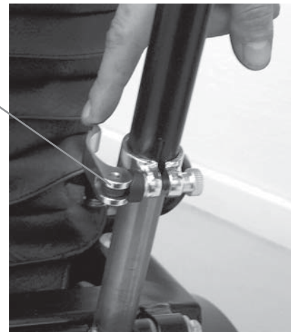
Figur 5 Quicklåse til justering af styrets højde.
