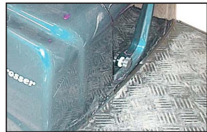
Fingerskruen på forsiden af bagskærmen drejes imod urets retning og tages helt af.
