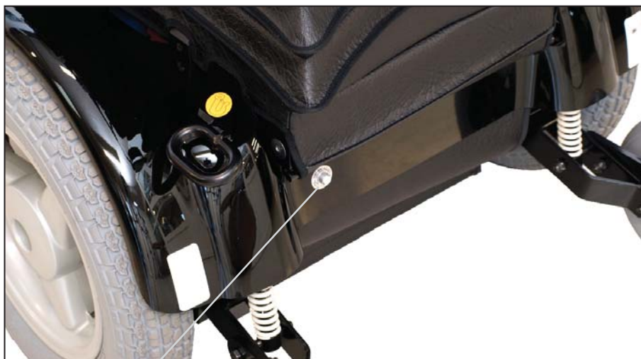
Her sidder termosikringen.
