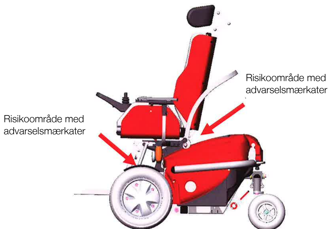
Fig. 54: områder med risiko for fastklemning
