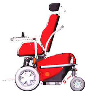
Fig. 12: sædet vipet 5° fremover
