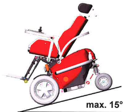
Fig. 55: maks. hældning ved kørsel ned ad bakke Fig. 56: sæde vippet bagover ved kørsel ned ad bakke
