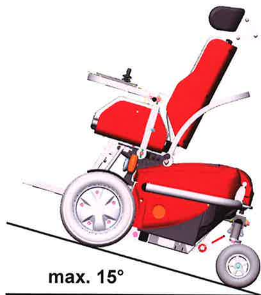
Fig. 57: maks. hældning ved kørsel op ad bakke
