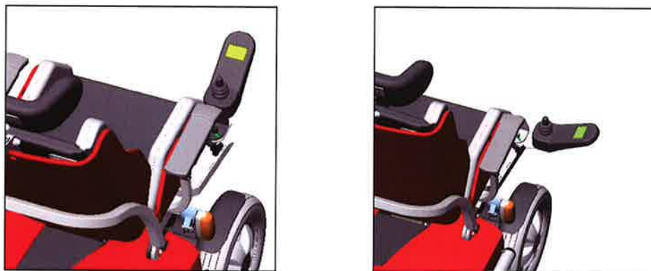
Fig. 91: drejeligt sidemonteret joystick
