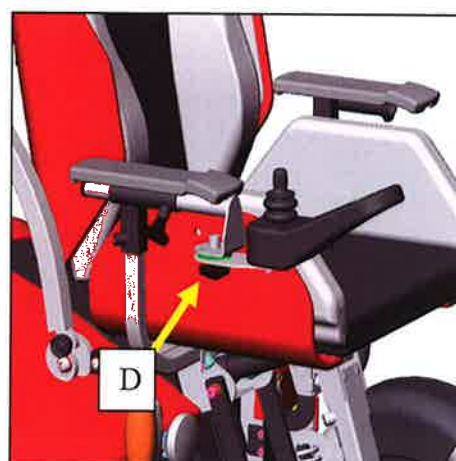
Fig. 47: friktionsjustering af sidemonteret joystick
