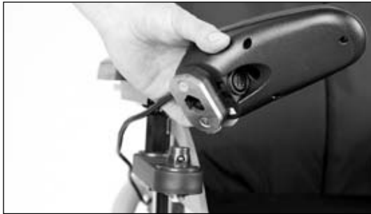
Afb. 14 Verwijderen van een bedieningseenheid met wegklapbare houder
