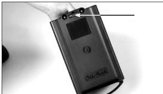
Ill. 30 Batteripakke med sikring
