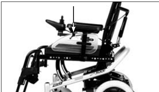
III. 25 Mekanisk indstilling af rygvinke
