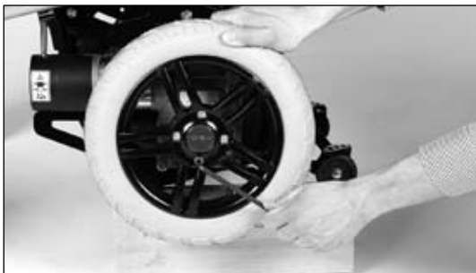
Afb. 31 Aandrijf wiel demonteren
