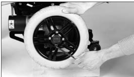
III. 31 Afmontering af drivhjul
