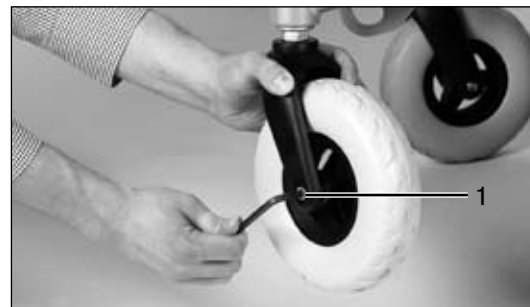
III. 32 Afmontering af forhjul
