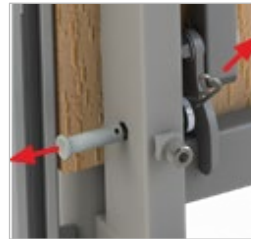
Αφαίρεση πείρου διχαλωτής σύνδεσης, αποστάτη και άγκιστρου τύπου 'R'
