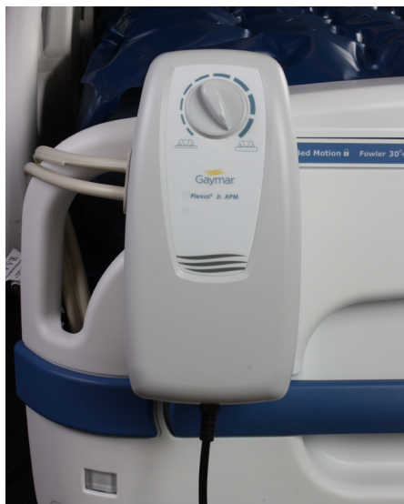
Fylde- og vedligeholdelsespumpe Plexus C-102
