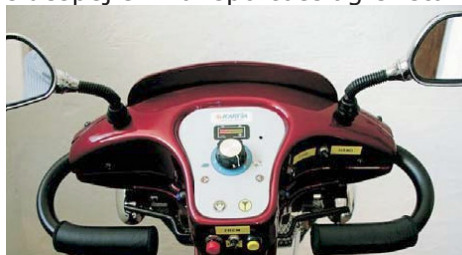
Overskueligt panel med batteriindikator og manuel hastighedsregulator. Trykkontakter for lys, horn og afviserblink. Brugervenlig "træk" fingerspeder.
