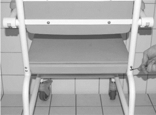
**DK:** De medfølgende skruer spændes ved hjælp af en unbrakonøgle. Sørg for at skruerne er spændt godt fast for at sikre sig, at ryggen stabilitet er sikker. Husk at efterspænde ryggen efter ca. 1 måned. Skruerne skal kasseres ved afmontering, og der skal benyttes nye skruer ved næste på montering.
