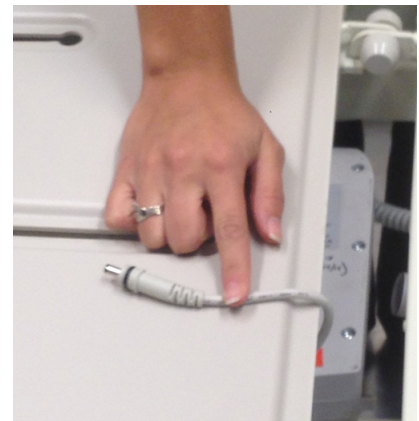
그림 14-5: 배터리 케이블을 컨트롤 상자에서 빼기
