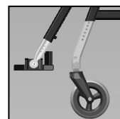
T2-H: 6 Löcher sichtbar
