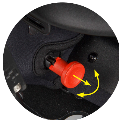
Hurtiglås - Åbnet (træk og vrid 90° til den sidder i et lille spor som holder den i åben position.)
