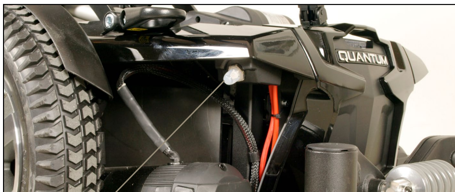
Her sidder automatsikringen.
