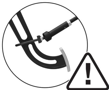
**Kontroller, at bremsestangen er korrekt monteret ved at rykke i bremsestangen.**
