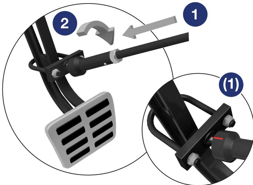
1 - Før bremsestangen ned mod beslaget på bremsepedalen, så den **røde** markering vender opad (1).
