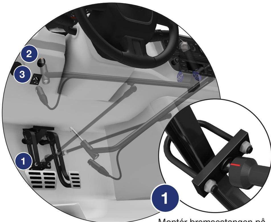
Montér bremsestangen på bremsepedalen. (Se 01a)
