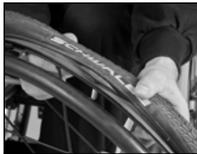
Fig. 69 Træk slangen ud
