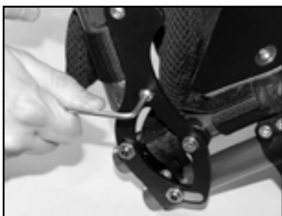
Fig. 20 Juster bolt til korrekt position
