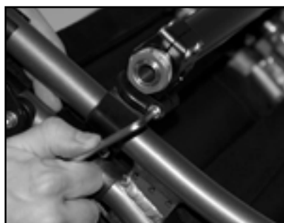
Fig. 50 Afmontér bagaksel med beslag
