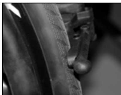
Fig. 44 Bremsen trykker korrekt på dækket
