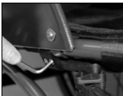
Fig. 43 Løsn boltene i konsollet
