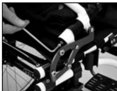
Fig. 21 Løsn og fjern bolt
