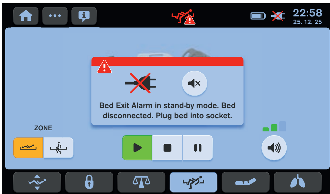
Fig. Bed Exit Alarm Monitoring (Sengealarm) er deaktiveret, fordi sengen er frakoblet lysnettet
