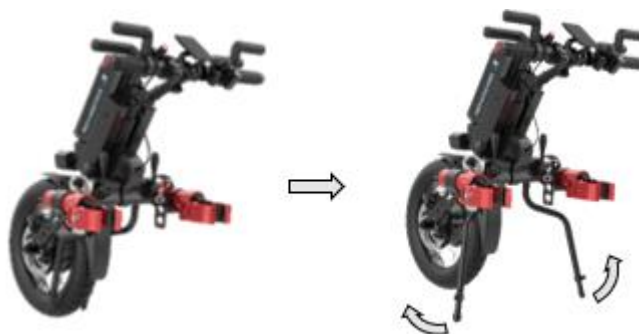
Figur 28. Omdrejning af støttenene til parkeringsposition
