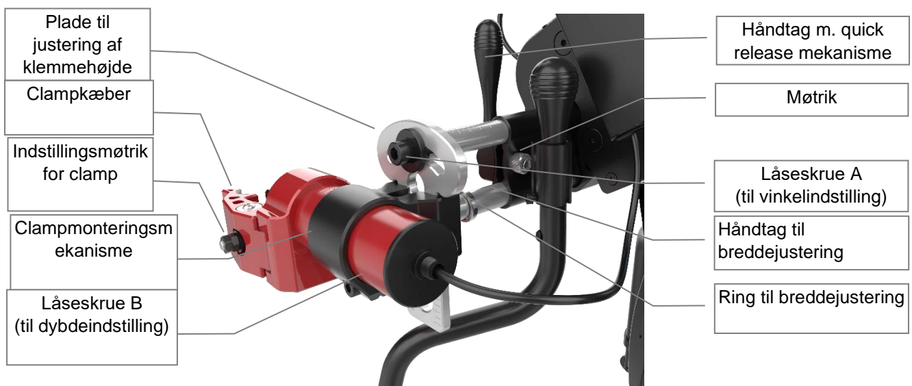
Figur 13. Monteringskomponenter til den automatiske clamp og breddejusteringssystemet
