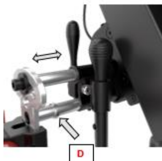
Figur 21. Justering af spændemøtrikken i forhold til breddejusteringshåndtaget.
