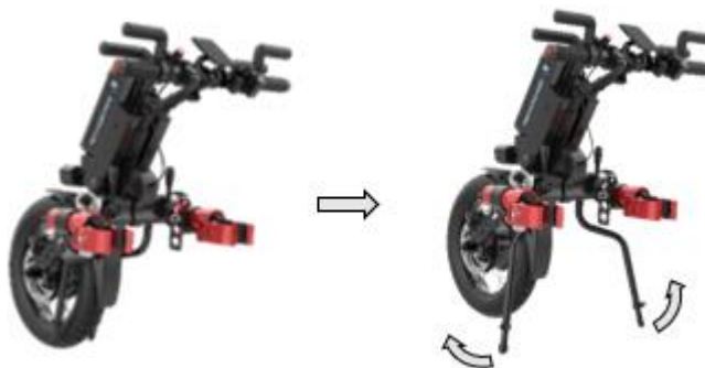
Figur 16. Drejning af støttebenene til parkeringsposition
