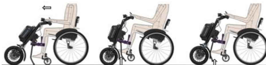
Figur 37. Parkerings- (1), City- (3) og Touring- (2) positioner for udstyrene m. en manuel clamp/lift
