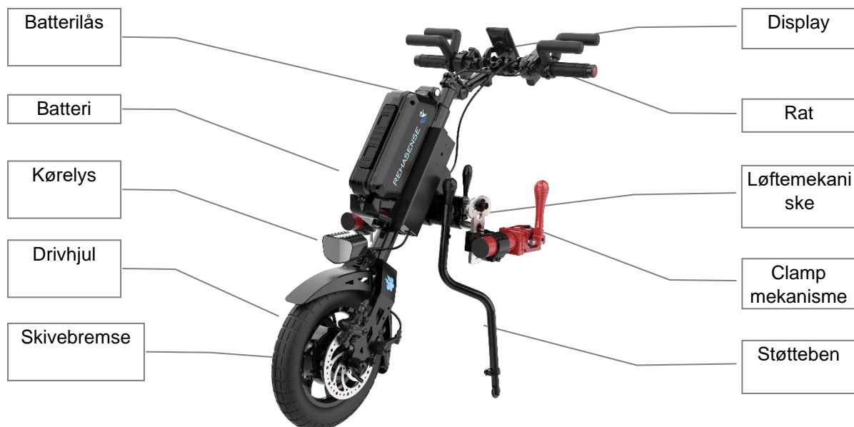
Figur 1. Udstyrets hovedkomponenter (figuren viser et eksempel på en manuel konfiguration af clamps og lift)
