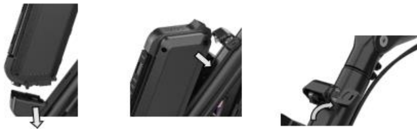
Figur 42. Anbringelse af batteriet i batteriholderen.
