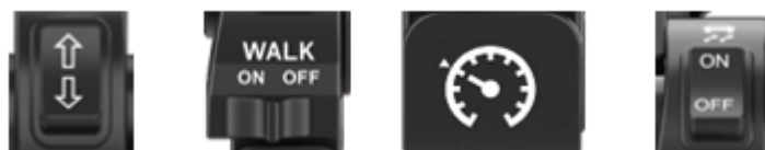
Figur 40. Kontakter og retningsindikatorer (fra V til H); Walk; Cruise; Traction.
