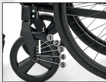
Les emplacements 1 à 5 correspondent à la position en hauteur de la roue dans la chape.
