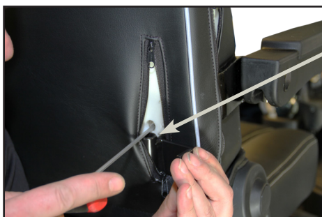
Lyn lynlåsen op og spænd beslaget fast med to skruer. NV 4mm.
