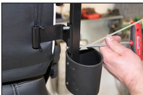
Fastspænd stokkeholderen med to skruer. NV 6mm.
