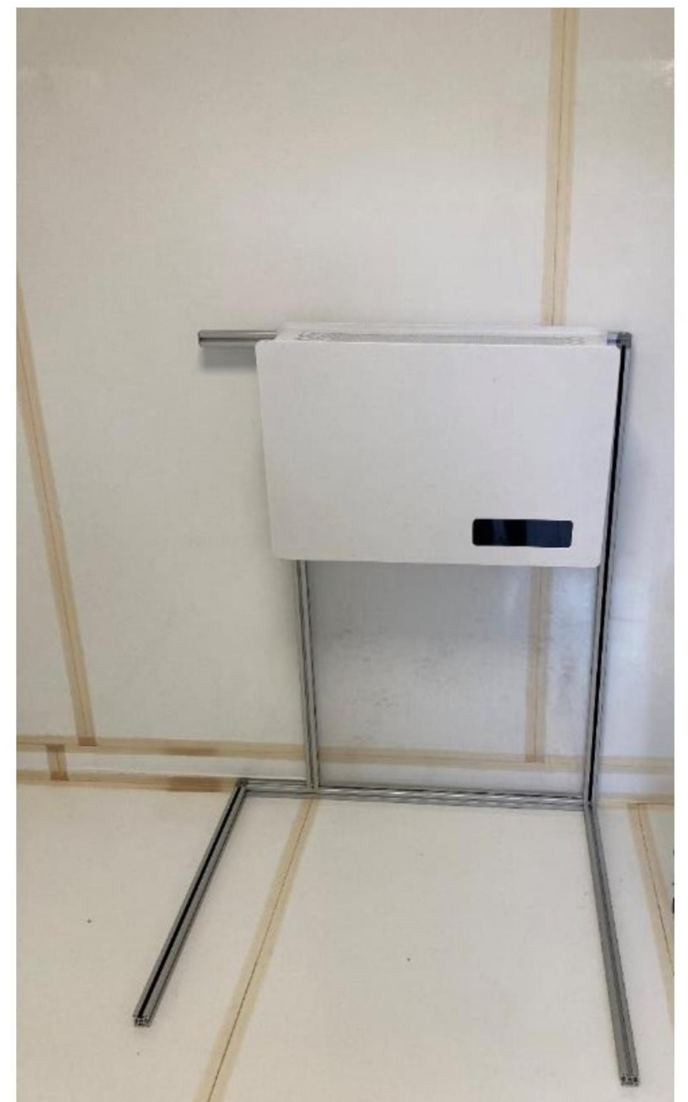
Figur 3: Luftrenser PureAir Wall 450 på vægophæng i testkammer
